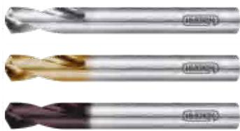
Центровочное сверло 120° для станков с ЧПУ из высококачественной легированной быстрорежущей стали Р6М5К5, обладающей высокой теплостойкостью. Точная заточка вершины с узкой перемычкой обеспечивает легкость центровки и точность центровочного отверстия.
